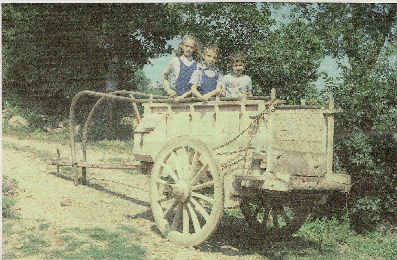
Foto 7 – Bambini sul carro. Sono ben visibili le stanghe intrecciate fra i prolungamenti dei montanti della fiancata; il cassetto (questo carro ne ha due); la ruota con il mozzo sporgente; la martinicca; la sponda sfilabile sul retro...
